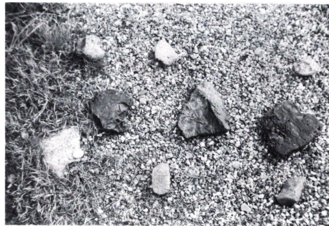
Trois morceaux de scories, spécimens de ces nombreux autres résidus solides de la fusion des minerais trouvés sur le site et dans l'Ure
